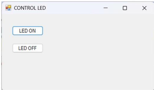
Si el código es correcto, cuando se presione el botón LED ON el LED en RC0 se encenderá y cuando se presione el botón LED OFF dicho LED deberá apagarse.
